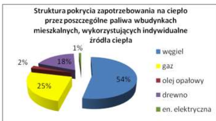
Rysunek 13. Struktura pokrycia zapotrzebowania na ciepło przez poszczególne paliwa w budynkach mieszkalnych, wykorzystujących indywidualne źródła ciepła (źródło: opracowanie własne na podstawie danych z ankiet)
